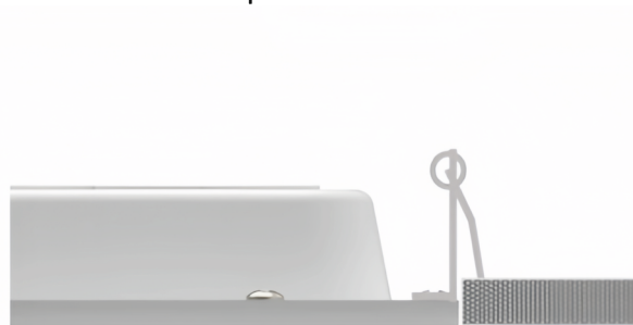
Монтаж светильника в в гипсокартонный потолок
